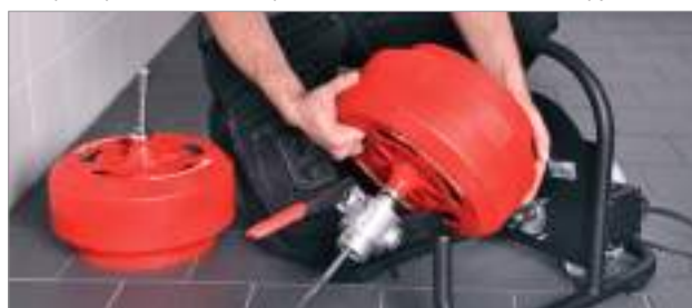
Быстрая простая замена барабанов без использования инструмента
