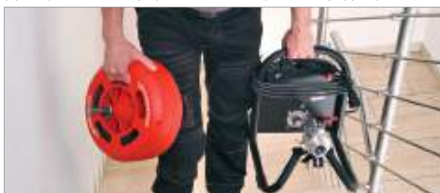
Для транспортировки барабан для спиралей снимается (при переноске части устройства можно держать в двух руках)
