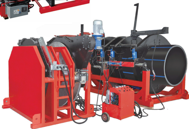
Фото 2. Сварочные машины SHENGDA марок A2SHDS160 (а) и SHD 2000 (б)
