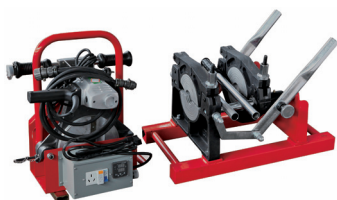
Фото 2. Сварочные машины SHENGDA марок A2SHDS160 (а) и SHD 2000 (б)
