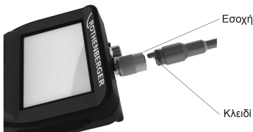
Εικόνα 6 - Συνδέσεις καλωδίου (σύνδεσμος τύπου "Α", μαύρος σύνδεσμος 9 ακίδων) (Για χρήση με τη στάντα μονάδα απεικόνισης που παρέχεται με τη συσκευή i2000 καθώς και με τη μονάδα απεικόνισης Module 25/16)
