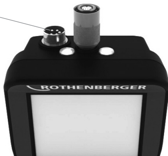
Pilt 7 - Kaabliühendused (pistmik „B“, värvus hõbedane, 5-pooluseline liitmik) (pistmikku „B“ kasutatakse ROSCOPE moodulite varasemate versioonide paigaldamiseks ROSCOPE i2000 külge)
