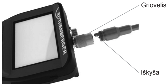
6 pav. Kabelių jungtys (kištukinė jungtis A, juodos spalvos, 9 kontaktų) (Skirta naudoti su TEC moduliu, tiekiamu su i2000, ir moduliu 25/16)
