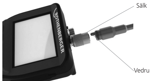
Pilt 6 - Kaabliühendused (pistmik „A“, värvus must, 9-pooluseline liitmik) (kasutamiseks mooduliga TEC, mis tarnitakse koos i2000-ga, ja mooduliga 25/16)
